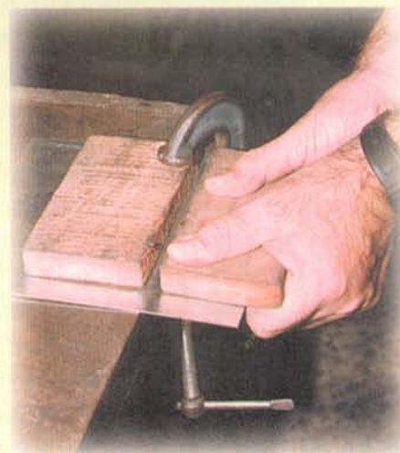
Figura 8.24. También se puede doblar la lámina con una prensa de banco y una pieza de madera
